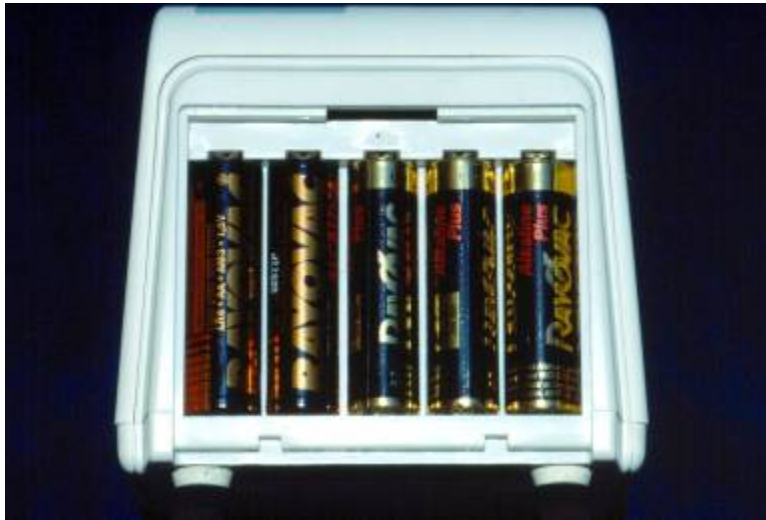
Figura 84. Localizador foraminal Root ZX. Compartimento das baterias, na base do equipamento (tampa aberta).
