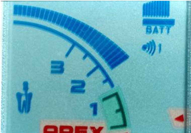
Figura 96. Visor do Root ZX , mostrando a progressão da medição nos últimos milímetros do canal radicular
