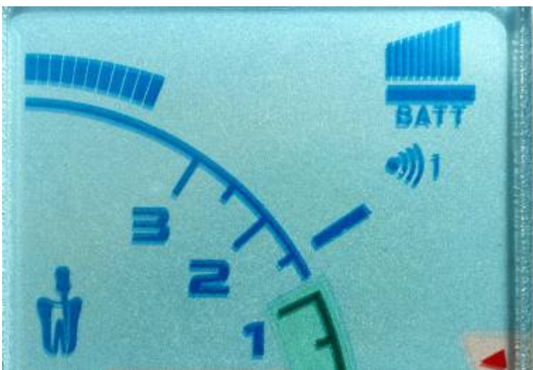
Figura 95. Visor do Root ZX , mostrando o início da medição. Desde a inserção do instrumento até sua aproximação acerca dos 3 últimos milímetros do canal radicular, não haverá significativa mudança no preenchimento das barras.
