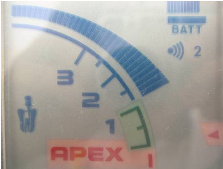
Figura 97. Visor do Root ZX , mostrando a progressão da medição nos últimos milímetros do canal radicular, referente à aproximação do instrumento à saída maior do forame.
