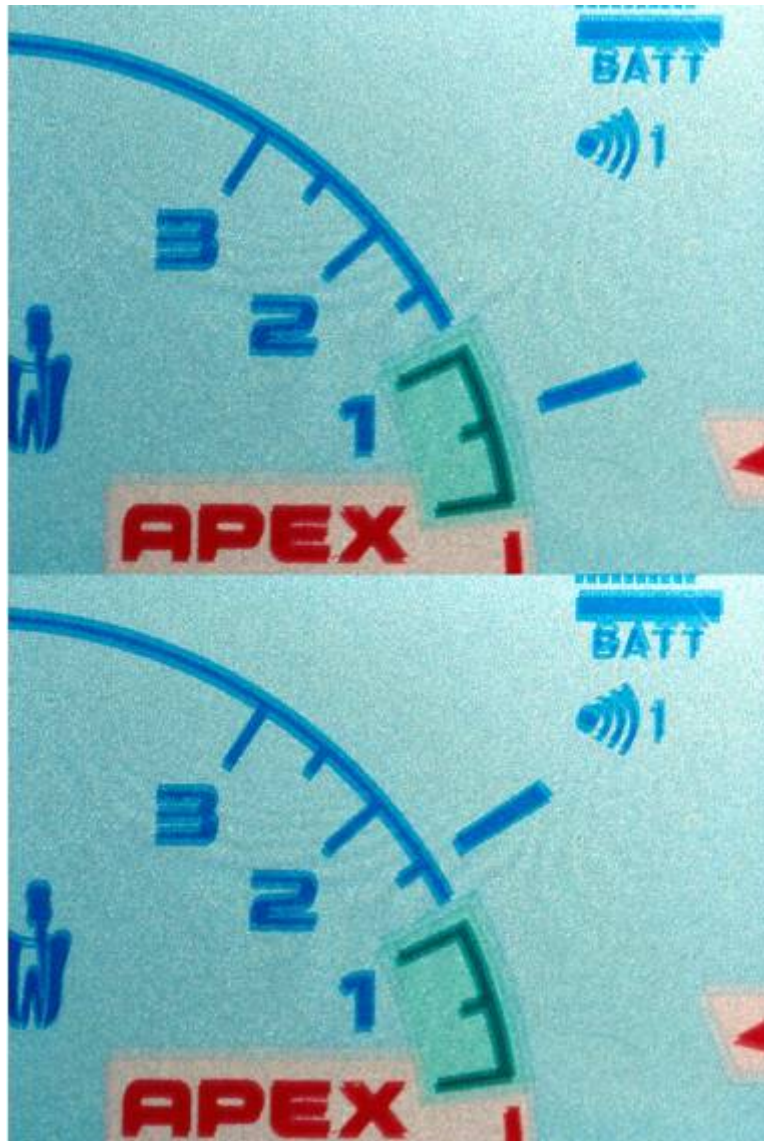
Figura 87. Visor do Root ZX. Acima: barra reta identificando o ponto, calibrado originalmente pelo fabricante, concernente ao limite ideal de instrumentação. Abaixo: após o ajuste sugerido, posicionando a barra reta entre os valores 2 e 1, conforme o texto.
