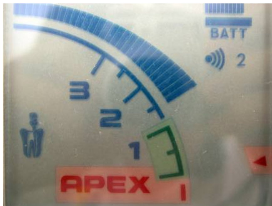
Figura 99. Visor do Root ZX , mostrando a posição referente à constrição apical, equivalente a aproximadamente 1mm aquém da saída maior do forame.
