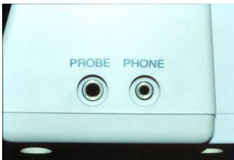
Figura 88. Visão lateral direita do Root ZX , mostrando os conectores para o cabo (“PROBE”) e para o fone de ouvido (“PHONE”).
