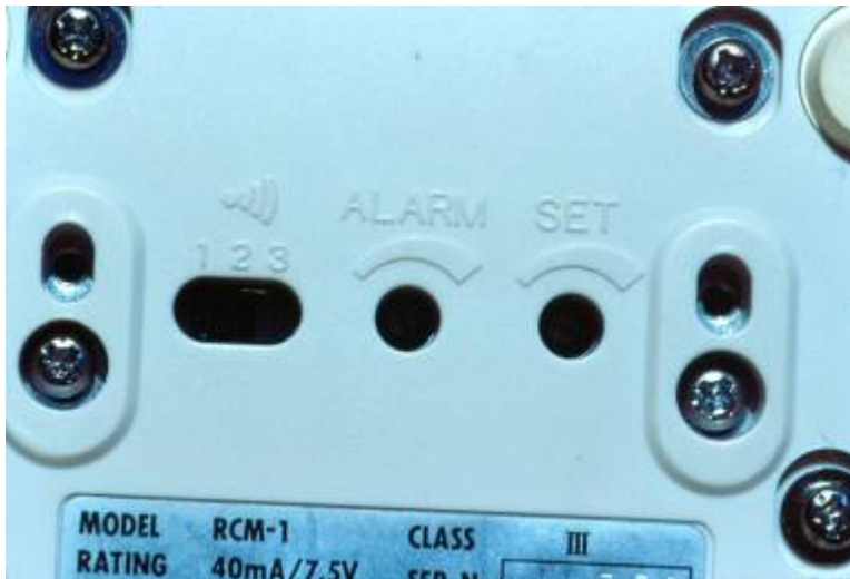
Figura 86. Localizador foraminal Root ZX . Vista da base do equipamento, mostrando as variáveis de ajuste, da esquerda para direita: tipo de campainha, volume da campainha e marcação para delimitação do comprimento de trabalho.
