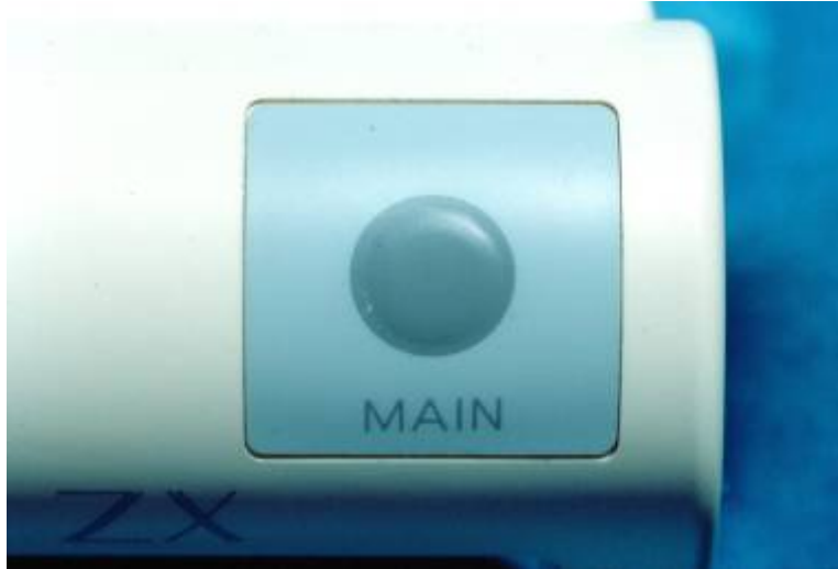
Figura 89. Vista superior direita do equipamento, mostrando o botão liga e desliga do localizador foraminal Root ZX.
