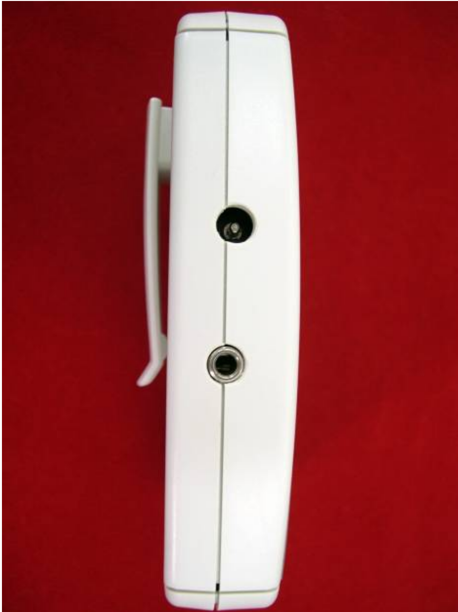
Figura 139. Vista lateral esquerda do Novapex. Receptáculo superior para o conector do carregador de bateria, e o inferior para o cabo do aparelho.
