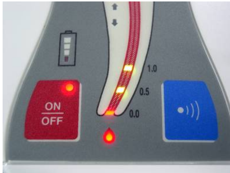
Figura 146. Visor do Novapex, mostrando a marcação referente à posição da ponta do instrumento inserido além do forame apical.
