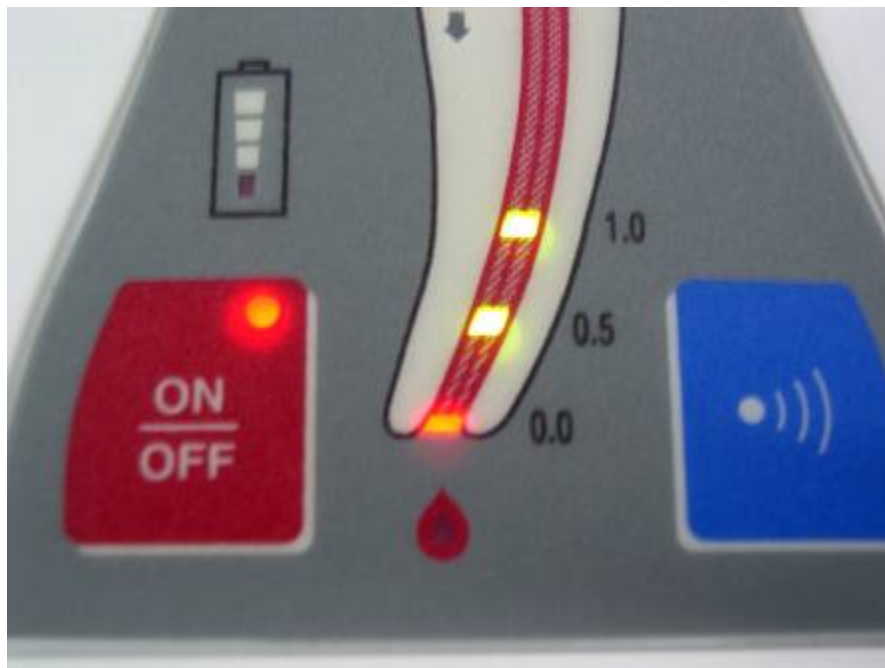
Figura 144. Visor do Novapex, mostrando a marcação referente à posição da saída do forame apical.
