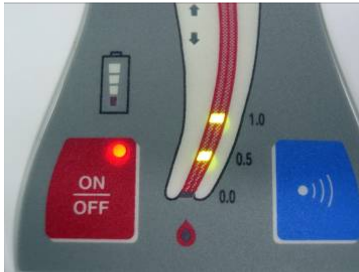
Figura 143. Visor do Novapex, mostrando os “leds” correspondentes às posições 1,0 e 0,5.
