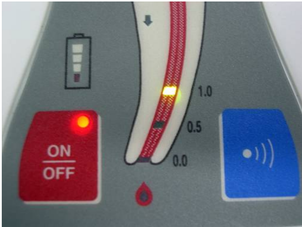
Figura 140. Painel do Novapex, com os botões de liga e desliga (esquerda) e ajuste de volume (direita).
