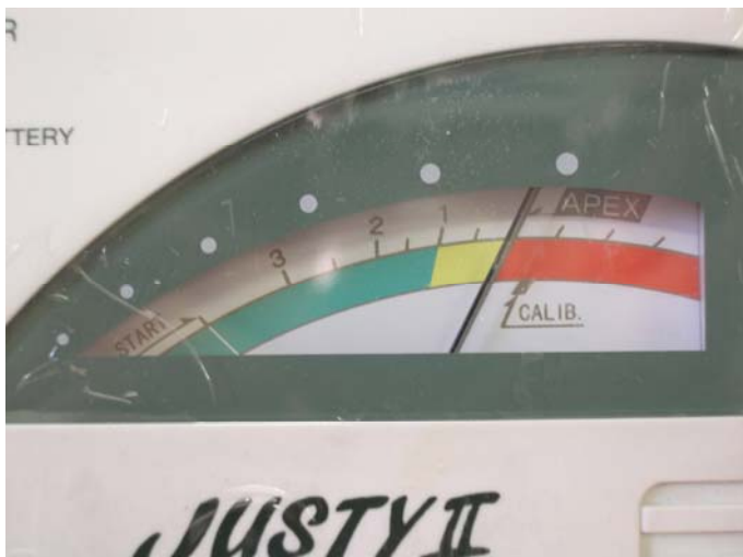
Figura 110. Visor do Justy II mostrando o ponteiro na posição "APEX", referente ao início da faixa vermelha.
