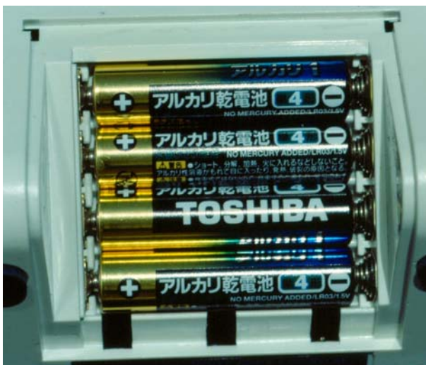
Figura 103. Compartimento das baterias, localizado na base do equipamento Justy II sem a tampa.
