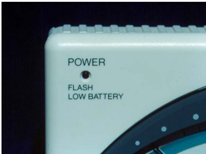
Figura 108. Detalhe do canto frontal superior esquerdo do Justy II, mostrando a sinalização de aparelho ligado (led vermelho contínuo) ou bateria fraca (led vermelho intermitente)
