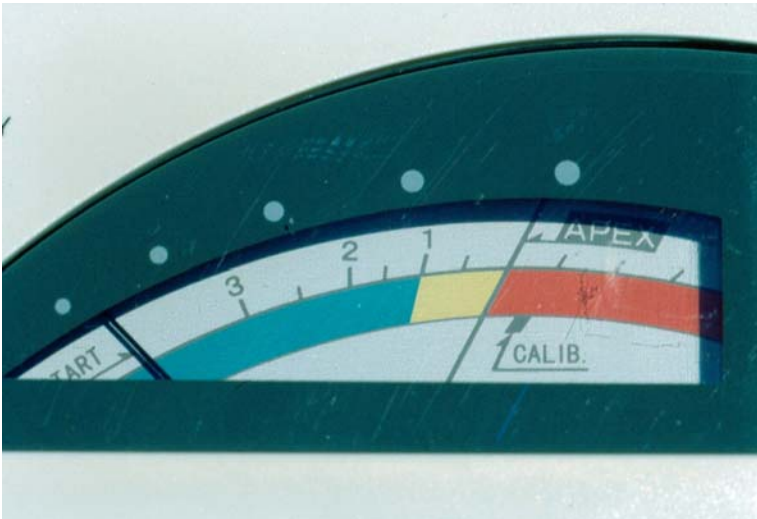
Figura 105. Visor do Justy II, mostrando a posição inicial do ponteiro sobre o limite “START”.
