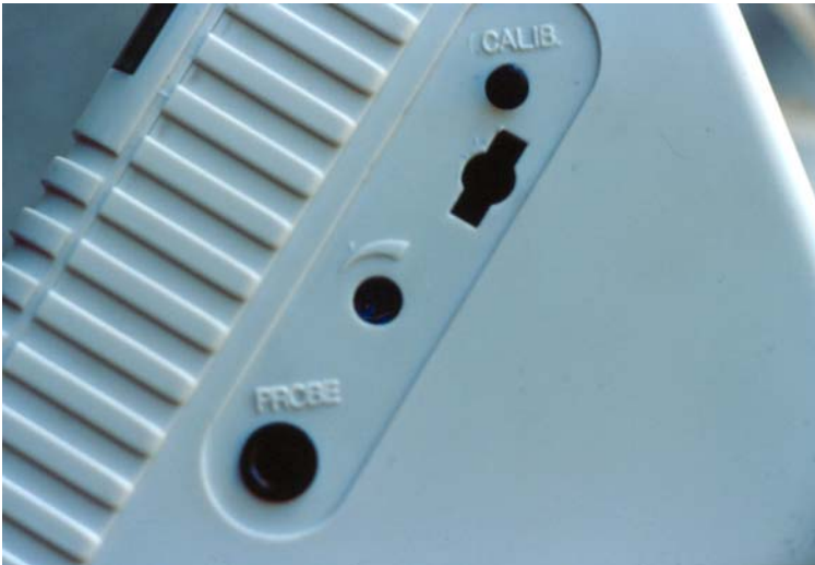
Figura 106. Visão lateral direita do Justy II , após a remoção do suporte para acondicionamento do cabo, mostrando, de baixo para cima, o conector do cabo “PROBE”, o ajuste de volume e o botão “CALIB”.
