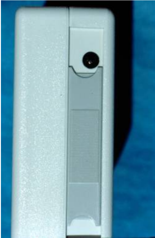
Figura 115. Visão lateral esquerda do Bingo 1020, mostrando a entrada para o conector do recarregador de bateria.
