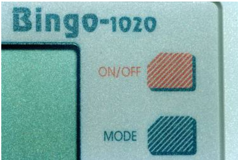
Figura 116. Visão frontal do canto superior direito do Bingo 1020, mostrando as teclas “ON/OFF” e “MODE”.
